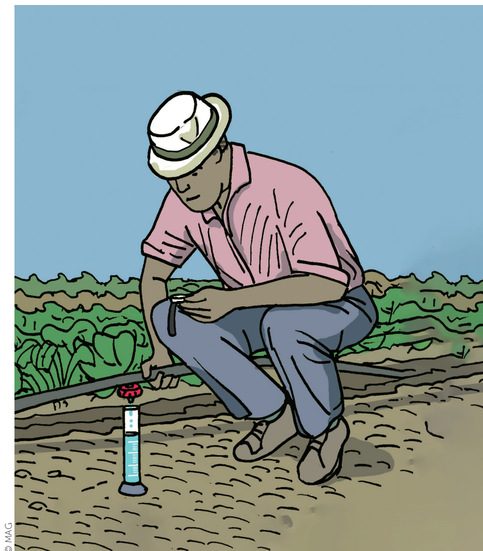
Aforo de goteros utilizando una probeta de 50 ml.
