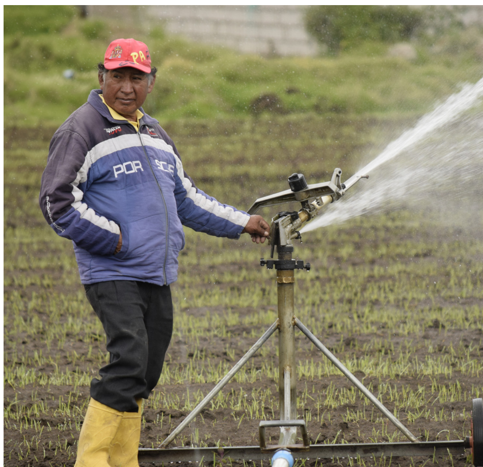
Peribuela – Imbabura. Gestor de riego realiza pruebas de funcionamiento de un aspersor.
