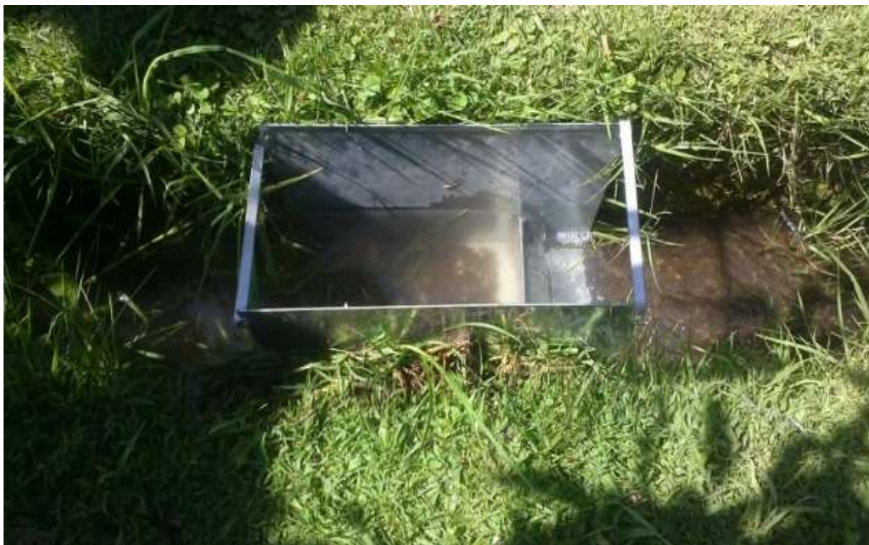
Figura 33. Vertedero rectangular sin contracciones.
