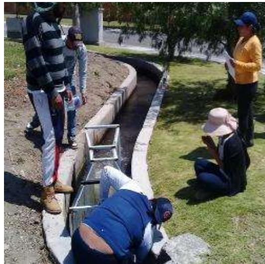
Fotografía 22. Colocación del canal de Parshall en el punto 1
