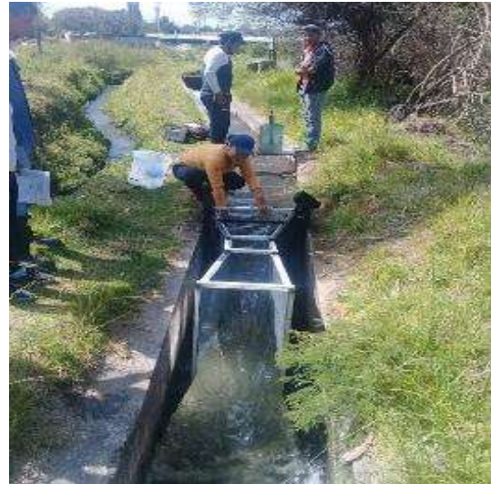
Fotografía 14. Ubicación del canal de Parshall en el punto 1
