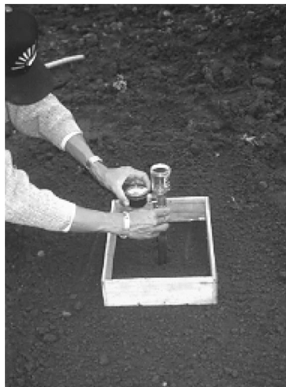
Figura 14. Instalación del tensiómetro en el campo.
