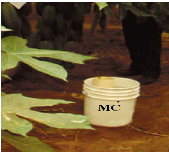
Figura 1. Instalación del lisímetro "MC".
