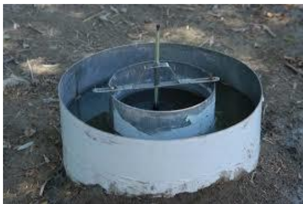
Figura 17. Infiltrómetro de doble anillo
