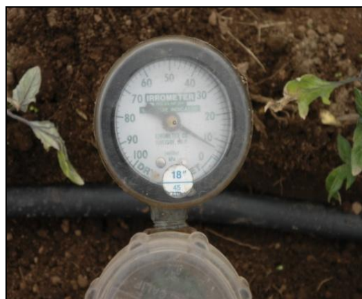
Fotografías 11. Toma de lecturas Humedad
