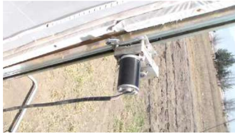
Figura10. Motor DC para el control de cortinas
