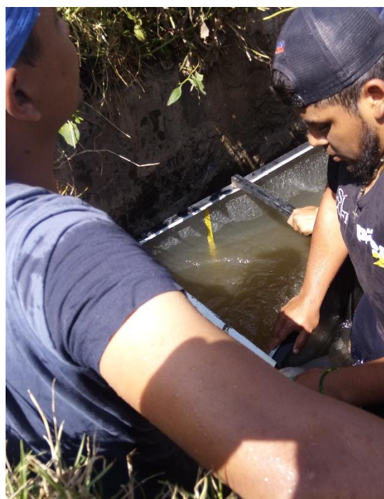
Fotografía 32.- toma de lecturas en la regleta
