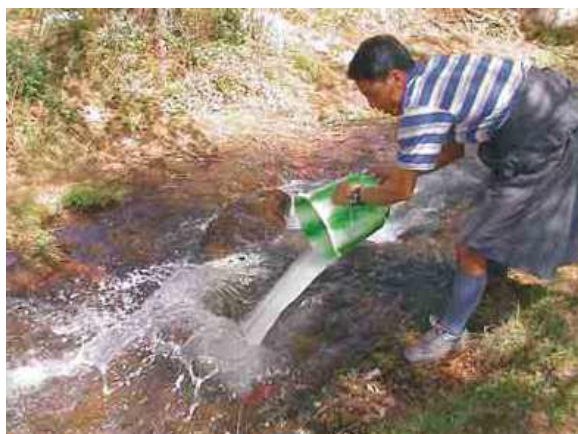
Fotografía 2. Primer balde lleno de solución de sal siendo vertido a la corriente, Butan. (Merz et al., 2006).
