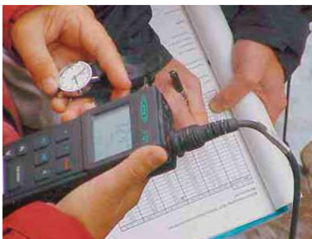
Fotografía 3. Tomando lecturas de conductividad cada cinco segundos. (Merz et al., 2006).
