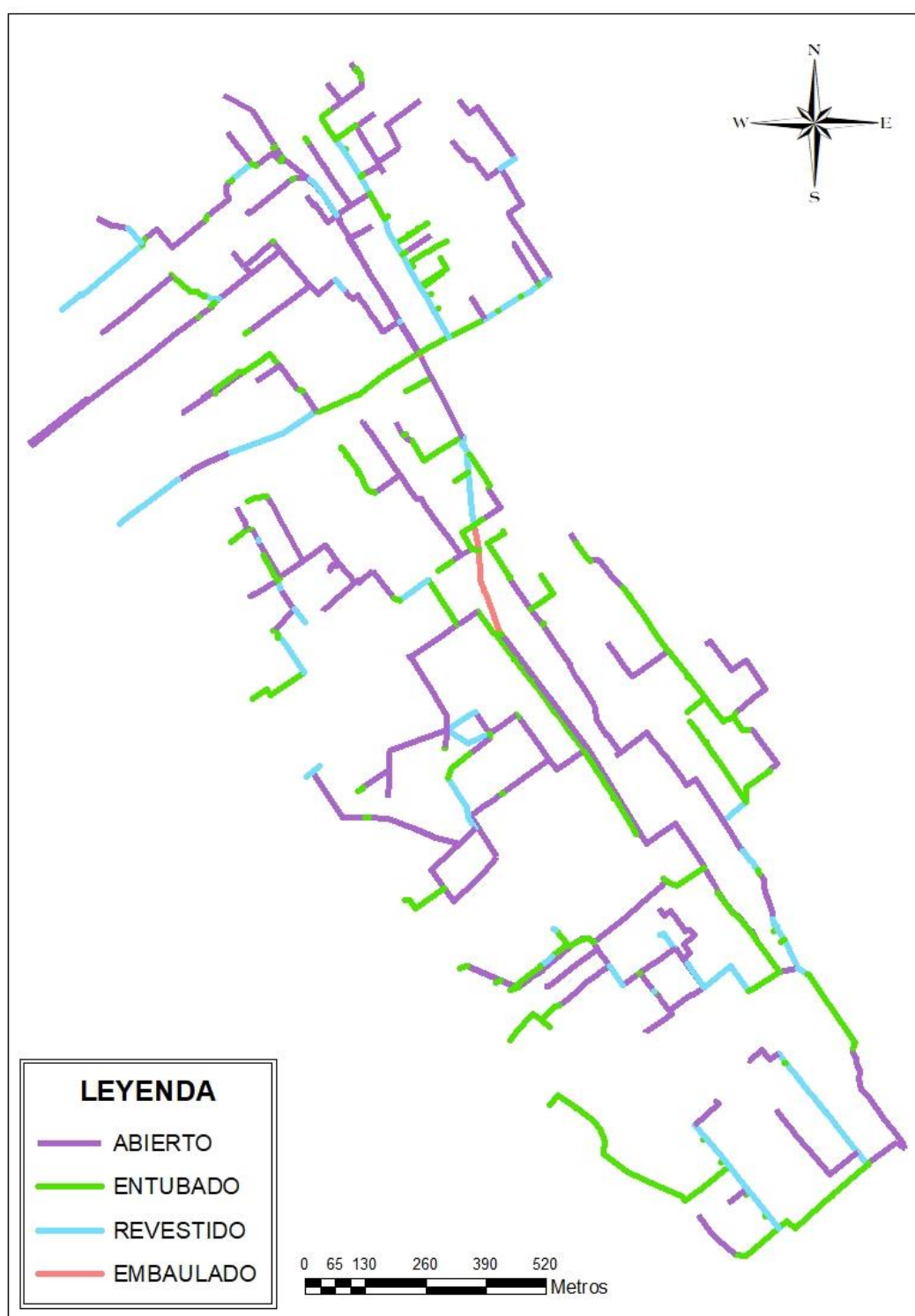
Figura 23. Infraestructura del canal de riego del Ramal Chichipata, Zona 2. 2016
