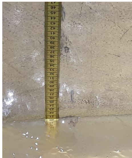
Figura 24. Medición de Caudal de Entrada a Ramal – Medidor Parshall 9 pulgadas
