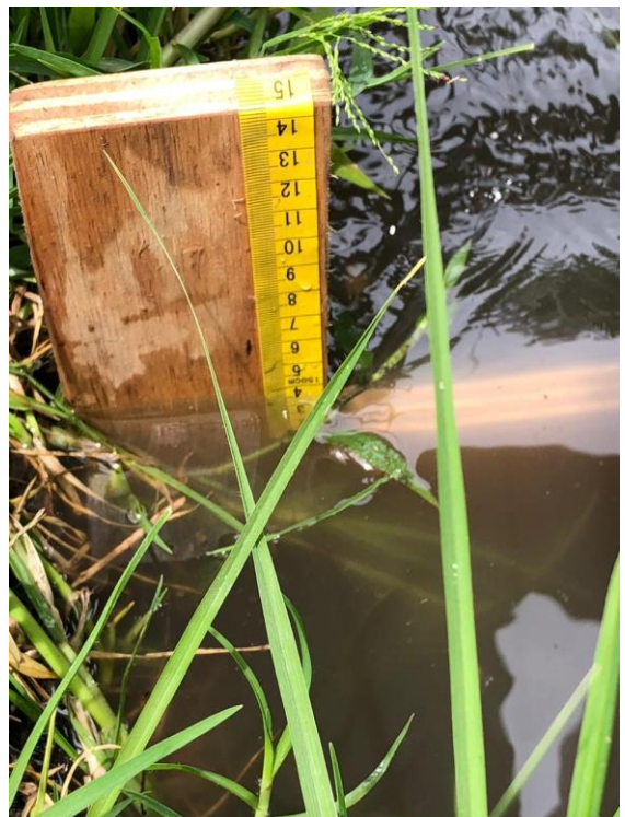
Figura 34. Medición de caudal de ingreso a parcela con vertedero rectangular de 30 cm
