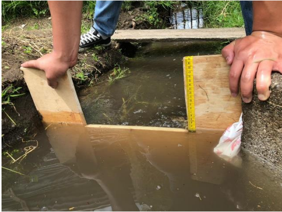
Figura 35. Medición de caudal de ingreso a parcela con vertedero rectangular de 60cm
