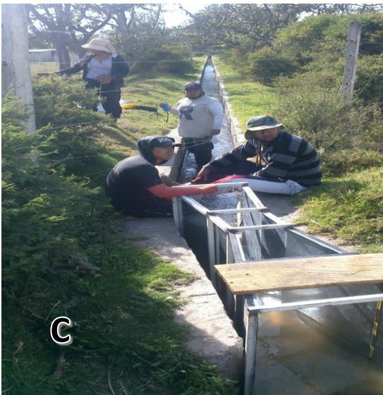
Fotografía 6. Medición de caudal en la S3P2 sector “Collaquí”: a) largo del canal revestido, b) instalación del aforador Parshall, c) medición con el aforador Parshall, d) registro de datos.
