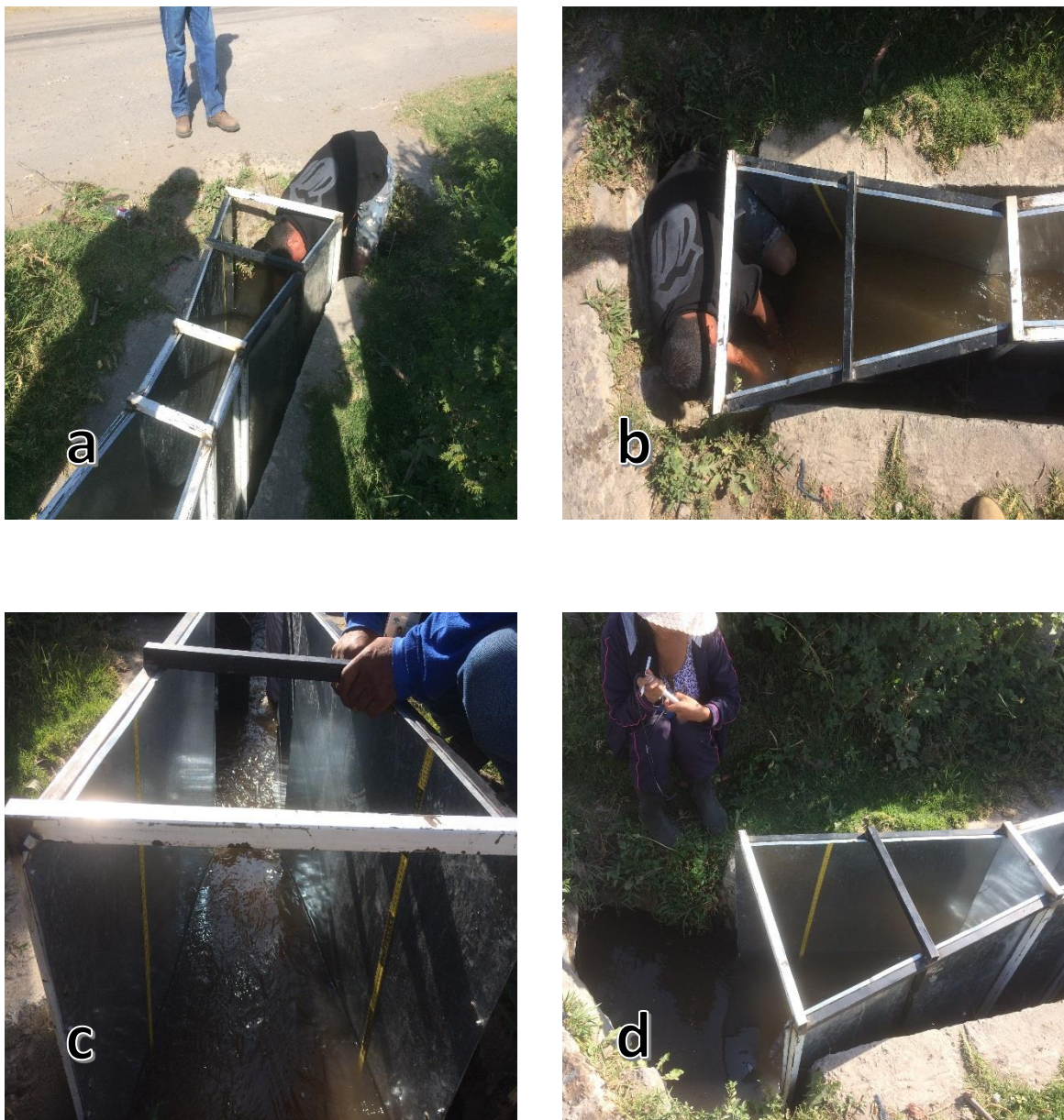
Fotografía 5. Medición de caudal en la S3P1 sector “Collaquí”: a) Instalación del aforador Parshall, b) limpieza de sedimentos alojados en la base del canal, c) medición con el aforador Parshall, d) registro de datos.
