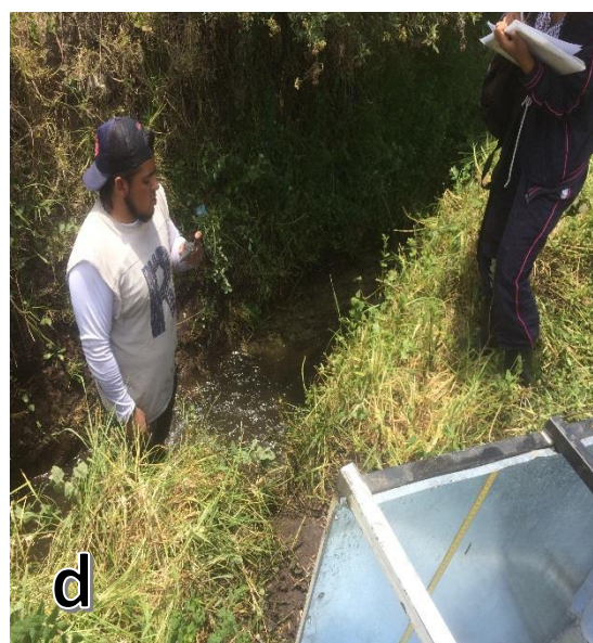
Fotografía 1. Instalación y medición de caudal en la S1P1 sector "Arenal": a) Ubicación de punto de monitoreo, b) limpieza del punto en el cual se ubicará el aforador Parshall, c) Instalación y medición con el aforador Parshall, d) grupo de registro de datos.
