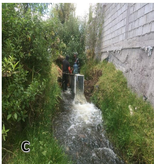
Fotografía 2. Medición de caudal en el S1P2 sector “Arenal”: a) limpieza del punto de medición, b) instalación y medición con el aforador Parshall, c) toma posterior del aforador Parshall, d) grupo de registro de datos.
