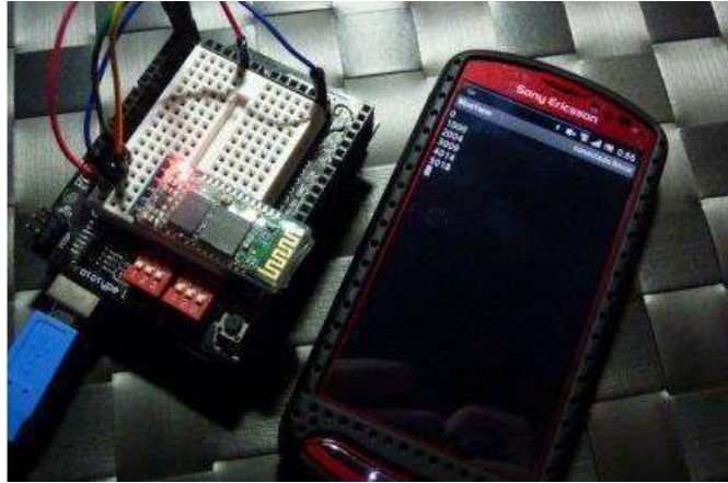
Figura 19-1. HMI por medio de Arduino y Smartphone Android
