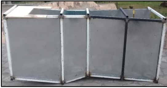
1. Vista lateral de la estructura del canal Parshall 9”.
