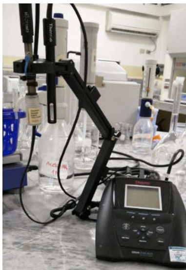
Figura 2.2 Medidor de conductividad
