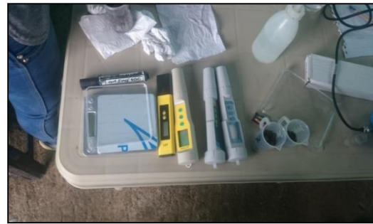
Fotografía 14.- Equipos usados en la medición de pH y conductividad eléctrica de la solución del suelo y del agua de riego.
