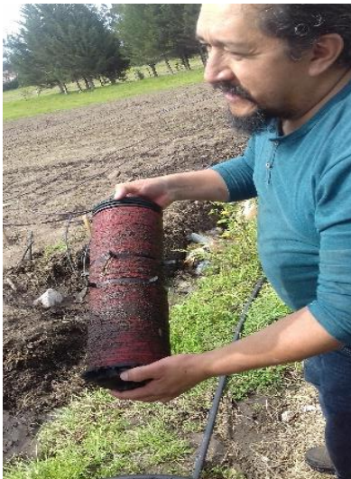
Anexo 18: Limpieza del filtro de anillas
